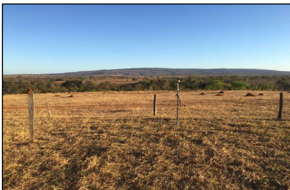
Figura 3 – Segundo receptor instalado no Marco BLO-M01
